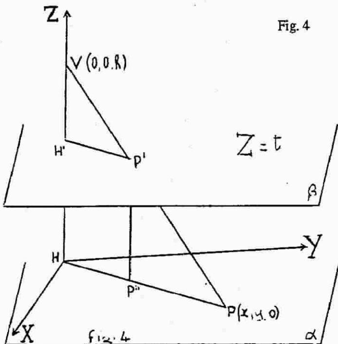
Possiamo pervenire alle equazioni della corrispondenza utilizzando anche il riferimento dello spazio (fig. 4). Diciamo  $(0, 0, h)$  le coordinate di  $V$  e indichiamo con  $(x, y, 0)$  le coordinate di  $P$ . L'equazione della retta  $VP$  nello spazio è:
