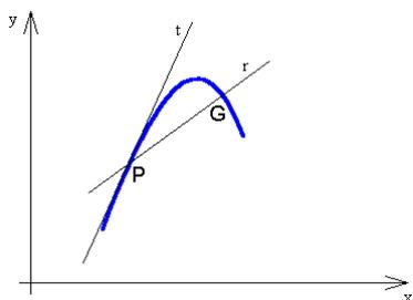
Si chiama tangente ad una curva piana in un suo punto P, la posizione limite, se esiste, della retta che unisce P con un altro punto G della curva, allorché si fa avvicinare G indefinitamente a P.
