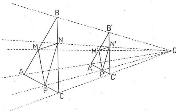
triangolo  $A'B'C'$  coi lati paralleli a quelli del triangolo dato. Per una nota proprietà le tre rette  $AA'$ ,  $BB'$ ,  $CC'$  concorreranno in un punto  $O$ . Unendo  $O$  con  $M'$ ,  $N'$ ,  $P'$  i punti di incontro  $M$ ,  $N$ ,  $P$  rispettivamente coi lati  $AB$ ,  $BC$ ,  $AC$  del triangolo  $ABC$  daranno i vertici del triangolo richiesto.
