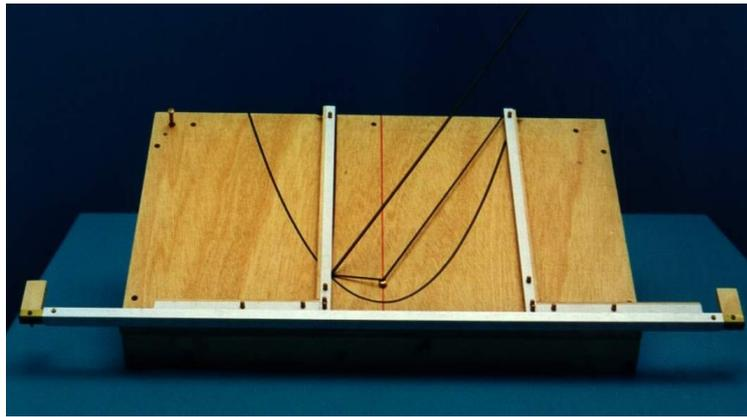
Possiamo allora tentare di migliorare la situazione utilizzando altre macchine che tracciano curve, ad esempio coniche. Tali macchine esistevano. Ad esempio, nella foto è riportata una macchina per tracciare parabole<sup>10</sup>.
