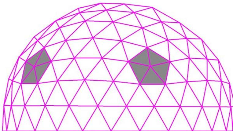
Figura 16. Semisfera geodetica 5v
