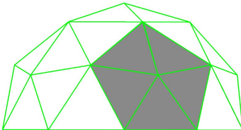
**Figura 13. Semisfera geodetica 2v**
